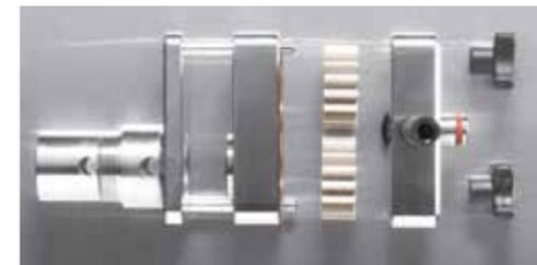
**Pompa di pressurizzazione** a ingranaggi che consente di ottenere una struttura costante del gelato erogato con 8 differenti possibilità di regolazione dell'overrun. La pompa è in acciaio inox AISI 304, costituita da pochi pezzi facili da smontare e pulire; ingranaggi in materiale PEEK per una più lunga durata nel tempo.
